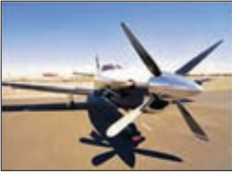
شکل ۸-۴-۱ ملخ پیچی است که هوا یا آب را می‌برد و به جلو می‌رود.
